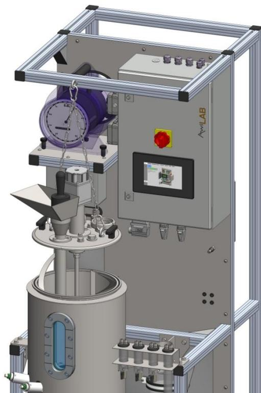
Figura 5: Suporte de montagem da tampa com misturador
