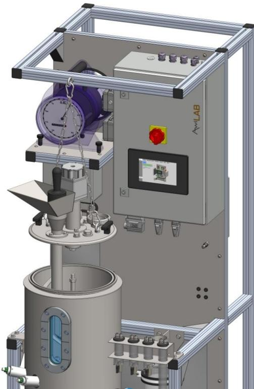
Figura 4: Suporte de montagem da tampa na estrutura
