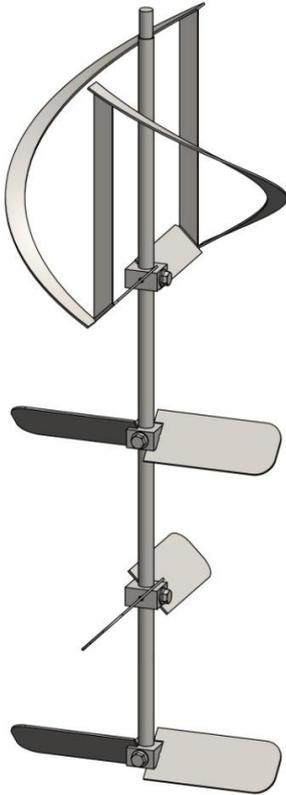
Abbildung 3: Rührwerk mit Standardeinbauten
