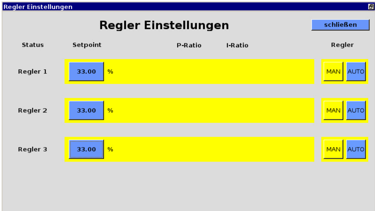
Abbildung 17: Admin > Regler, manuelle Regelung der Luftzugabe
