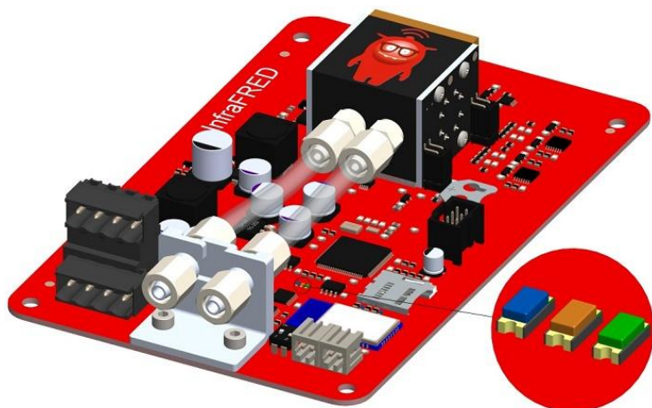
Abbildung 31: Status LEDs Multigassensor InfraFRED
