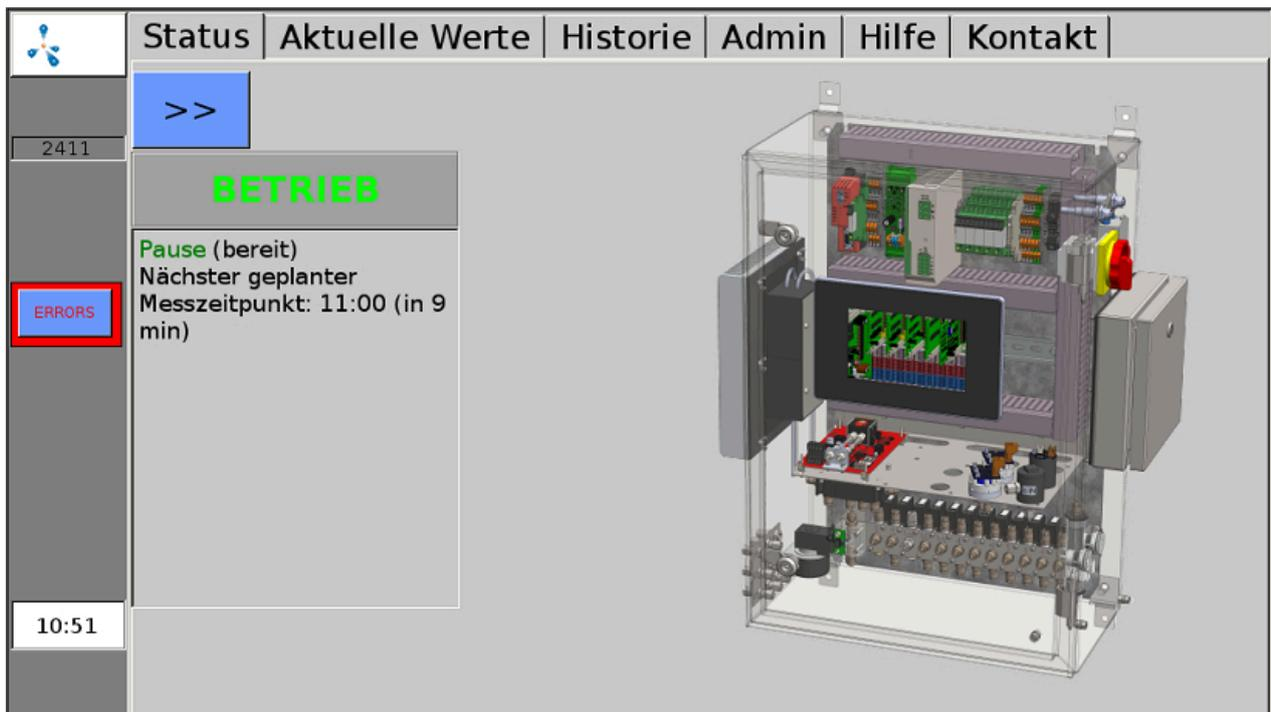
Abbildung 14: Aktuelle und nicht bestätigte Fehler (Roter Knopf) werden am linken Bildschirmrand angezeigt
