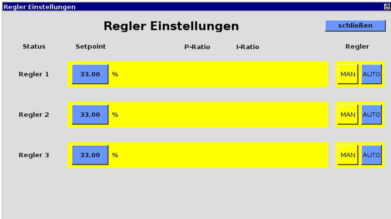
Abbildung 17: Admin > Regler, manuelle Regelung der Luftzugabe
