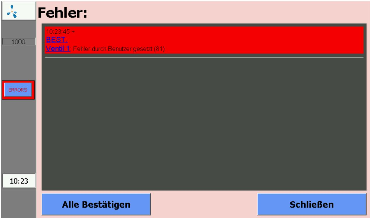
Abbildung 15: Fehlerfenster zeigt eine Liste der aufgetretenen Fehler
