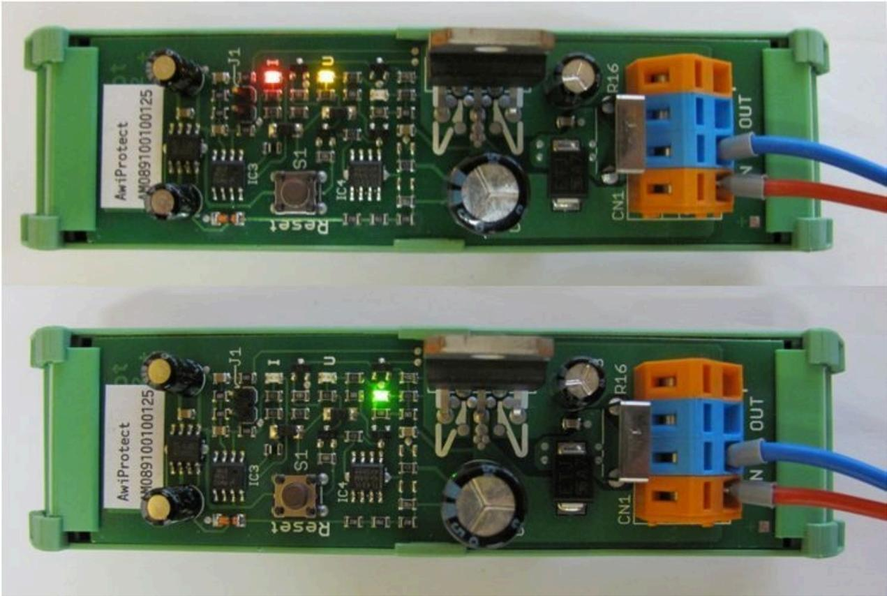
Figura 11: Modulo AwiParam con i LED, che indicano lo stato di funzionamento corrente
