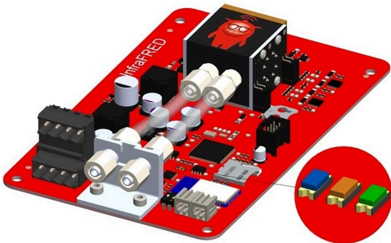
Figura 14: LED di stato sensore multigas InfraFRED
