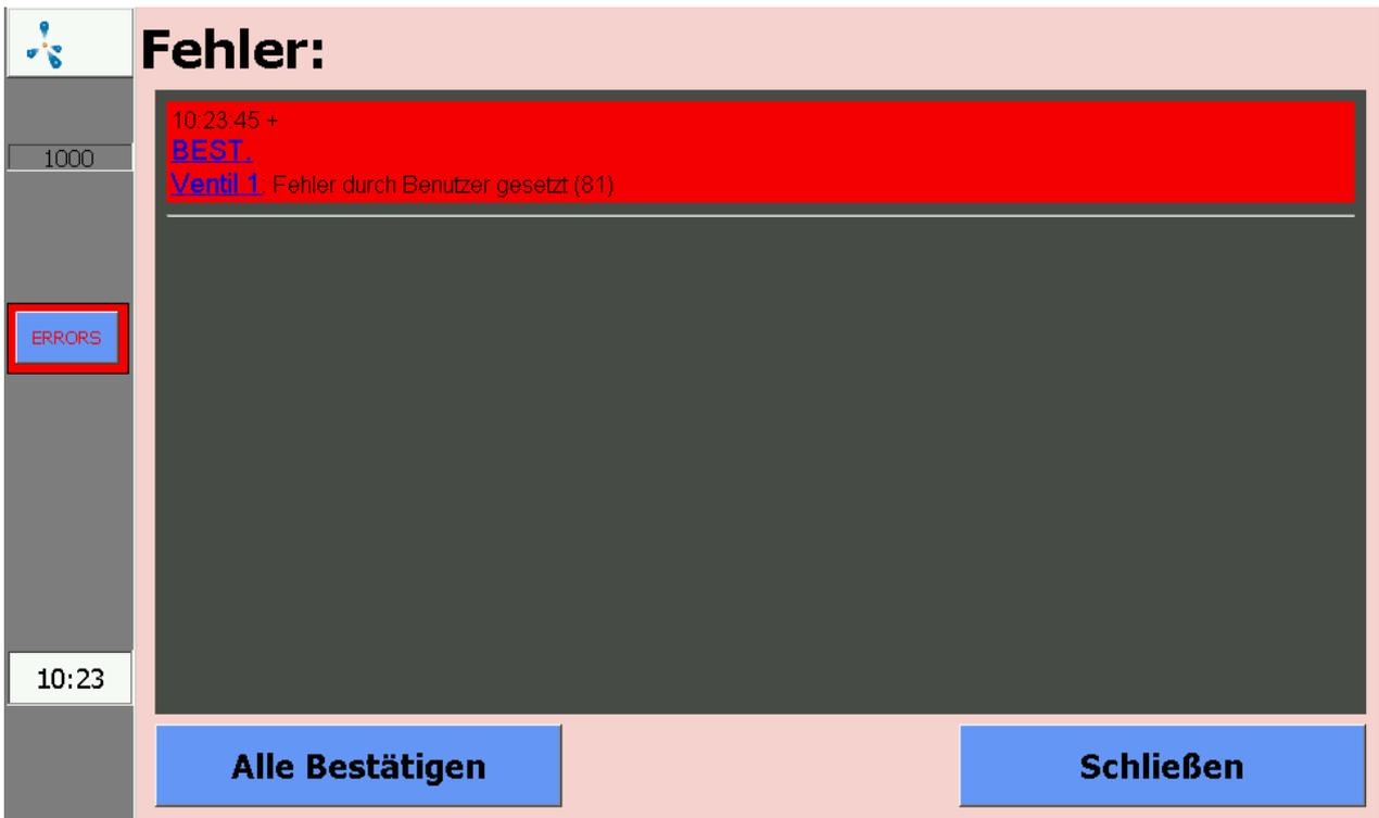
Abbildung 13: Fehlerfenster zeigt eine Liste der aufgetretenen Fehler
