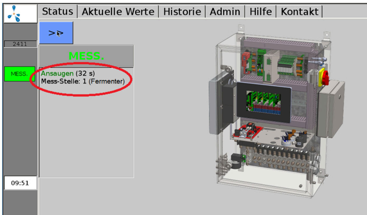
Abbildung 3: Anzeige im Statusfenster während des Ansaugens vor der Messung
