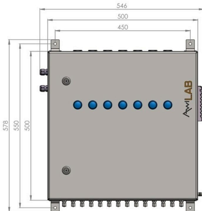
Figura 23: Dimensioni di ingombro per AwiLAB
