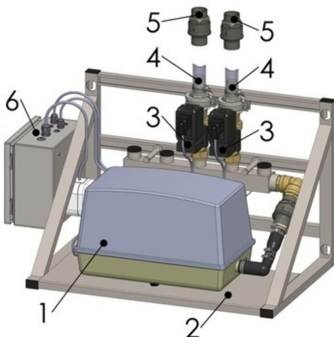
Figura 11: Struttura schematica AwIDESULF 100 – Rappresentazione esemplificativa
