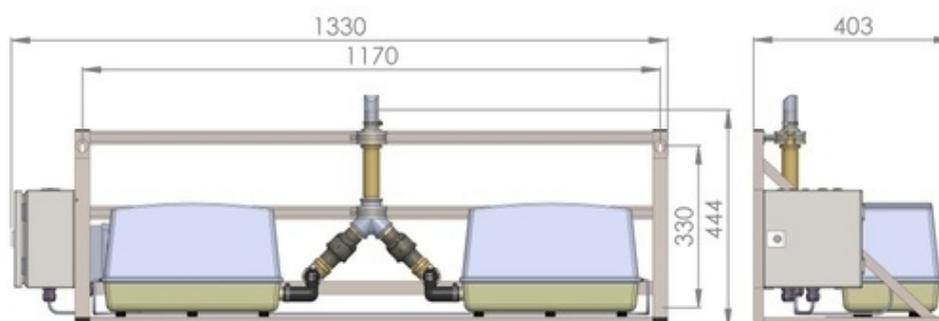
Figura 18: Requisiti di spazio per AwIDESULF 200 UL/CSA – Raffigurazione
