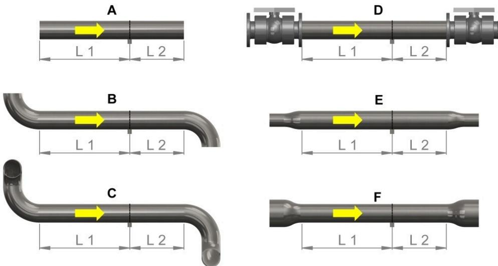
Figura 10: Tratti di entrata e di uscita del sensore di flusso AwiFLOW
