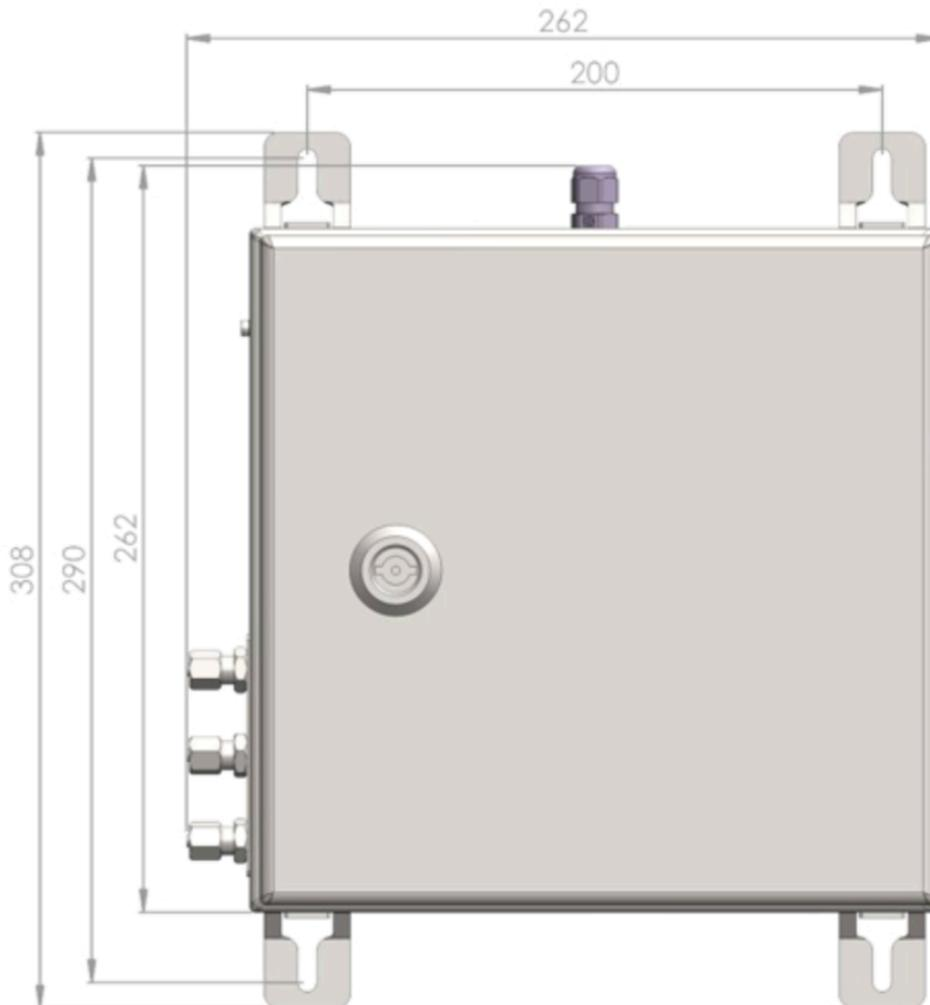
Figura 25: Requisiti di spazio per AwiVac
