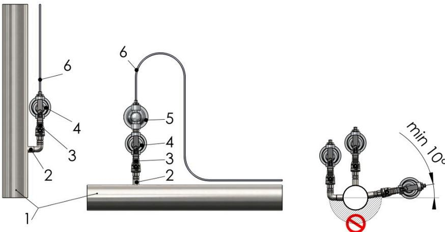
Figura 6: Punto di prelievo sul lato superiore di una condotta del gas con rubinetto manuale e filtro del gas.
