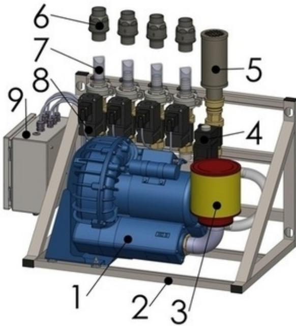
Figura 14: Struttura schematica AwiDESULF 300/500 – Rappresentazione esemplificativa
