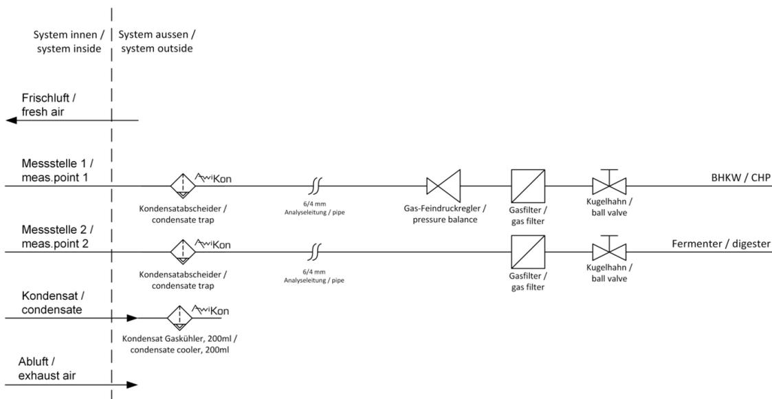
Figura 7: Disposizione schematica dei punti di prelievo del gas di analisi – Raffigurazione esemplificativa
