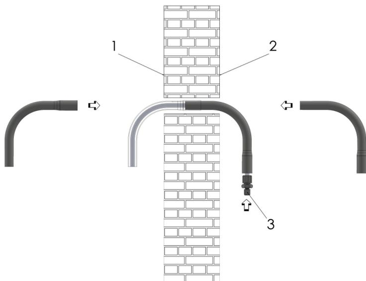
**Figura 8: Montaggio della condotta dell'aria di scarico**
