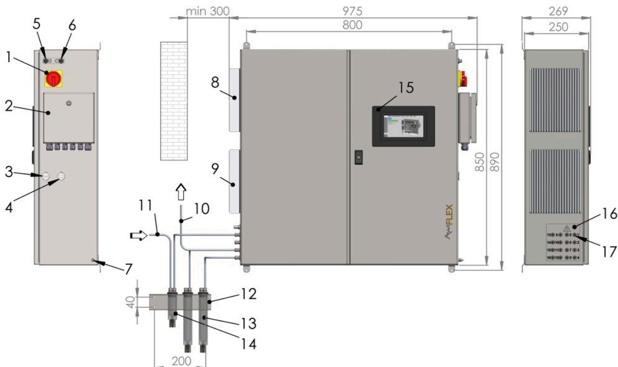
Figura 1: AwiFLEX XL compresi i separatori di condensa posti all'esterno.
