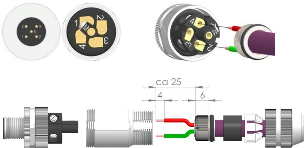
Figura 4: Piedinatura dei pin del connettore Profibus
