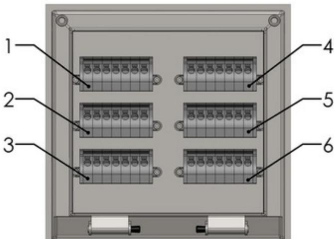
Figura 3: Cassetta terminale sistema di analisi AwiFLEX XL
