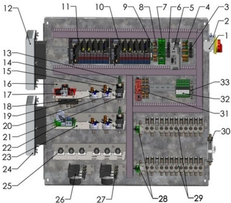
**Figura 2: Gruppi costruttivi nel sistema di analisi gas Awiflex XL**
