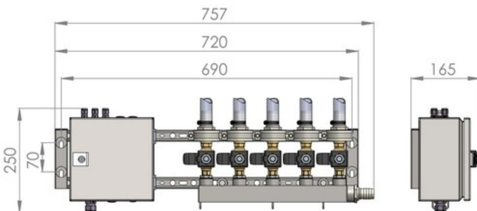
Figura 21: Requisiti di spazio per AwiDESULF PureOxygen – Raffigurazione esemplificativa
